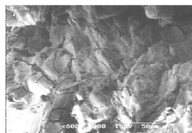
(d) inner of sample at 1550^{\circ}\text{C} ( \times 1000 )
